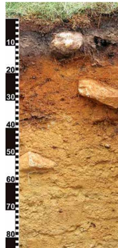
Podsole entstehen in stark sauren Böden, wenn Tonminerale zerfallen und gelöste Eisen- und Aluminiumverbindungen in tiefere Schichten wandern. Dadurch kann der Boden Nährstoffe schlechter speichern. Foto: BFW
